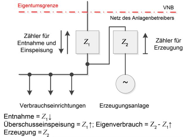
**Messkonzept 4 - KWK-Untermessung (§ 6 Abs. 3 KWKG 2015, geändert 2017)**
